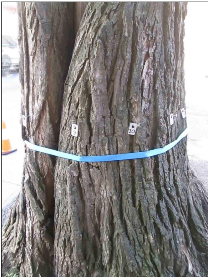
Photo 11e : Position des capteurs du tomographe à 80 cm du sol
