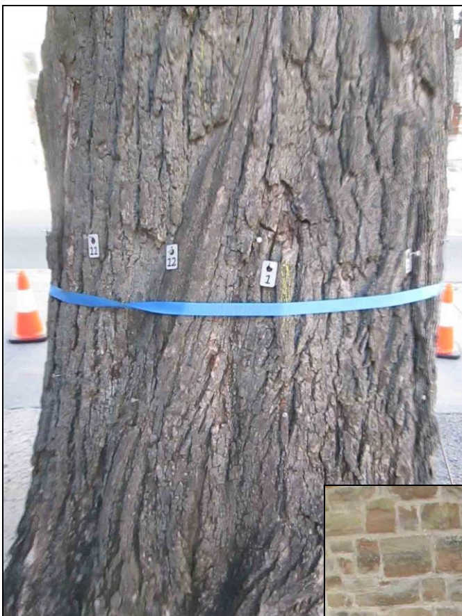
Photo 11a : Position des capteurs du tomographe à 80 cm du sol
